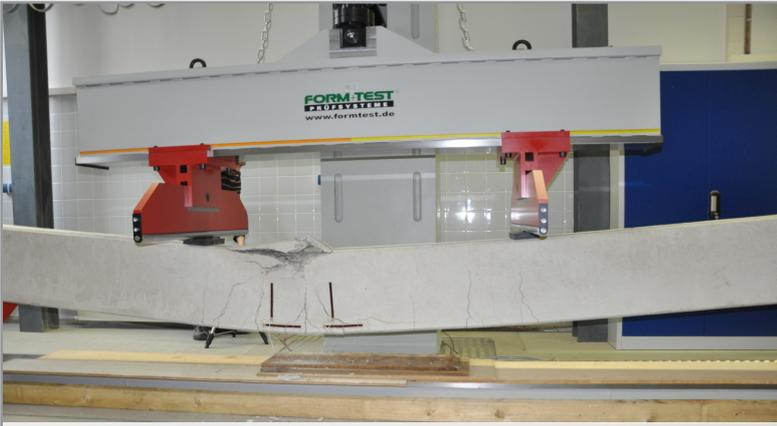
400 kN Biegeprüfmaschine für Balken bis 7m Länge
