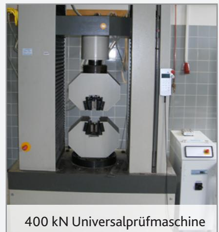
400 kN Universalprüfmaschine
