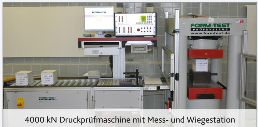
4000 kN Druckprüfmaschine mit Mess- und Wiegestation
