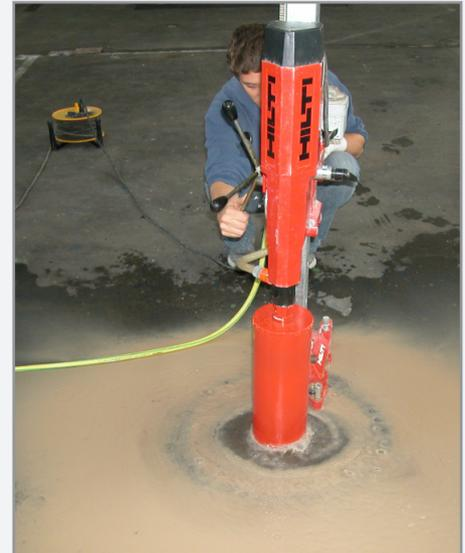
Entnahme von Bohrkernen (in situ)
