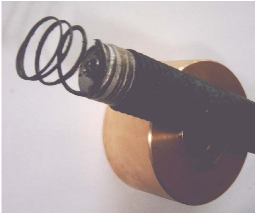
Untersuchungen über die statische Tragfähigkeit von Einschraubverbindungen
