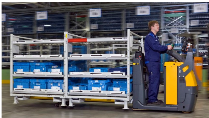
Abb. 8: Horizontal-Kommissionierer zur Aufnahme von zwei mit KLT beladenen Gestellen [Mercedes-Benz]
