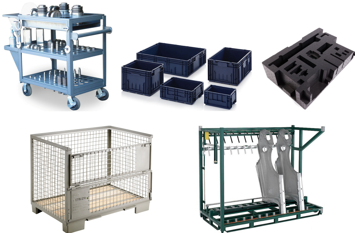
Abb. 4: Minomi-Konzept zur ladungsträgerfreien Materialbereitstellung (oben links), Standard-KLT in modularen Größen (oben Mitte), Set-Behälter zum Transport mehrerer Produkte ohne trennende Zwischenschicht (oben rechts), EURO-Gitterboxpalette (unten links) und Spezial-Transportgestell für Fahrzeugsitze (unten rechts) [CEC; AUER Packaging; Fromm Fördertechnik; EPAL; Elkas]
