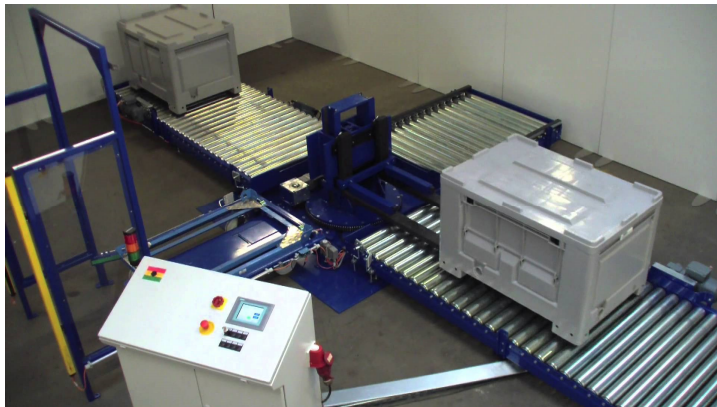
Abb. 16: Umsetzstation zur automatischen Beladung von Trolleys mit GLT [M.W.B.]
