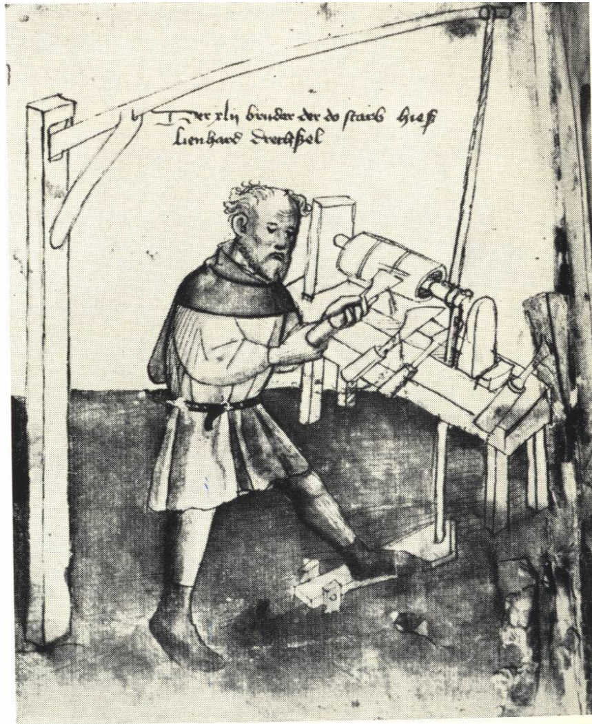
b. Drehselbank mit Wippe und Fußantrieb, um 1395. Bild aus dem Hausbuch der Mendelschen Zwölfbrüder-Stiftung in Nürnberg. Album 1: 1388—1545. Fol. 18v. Nürnberg, Stadtbibliothek.
