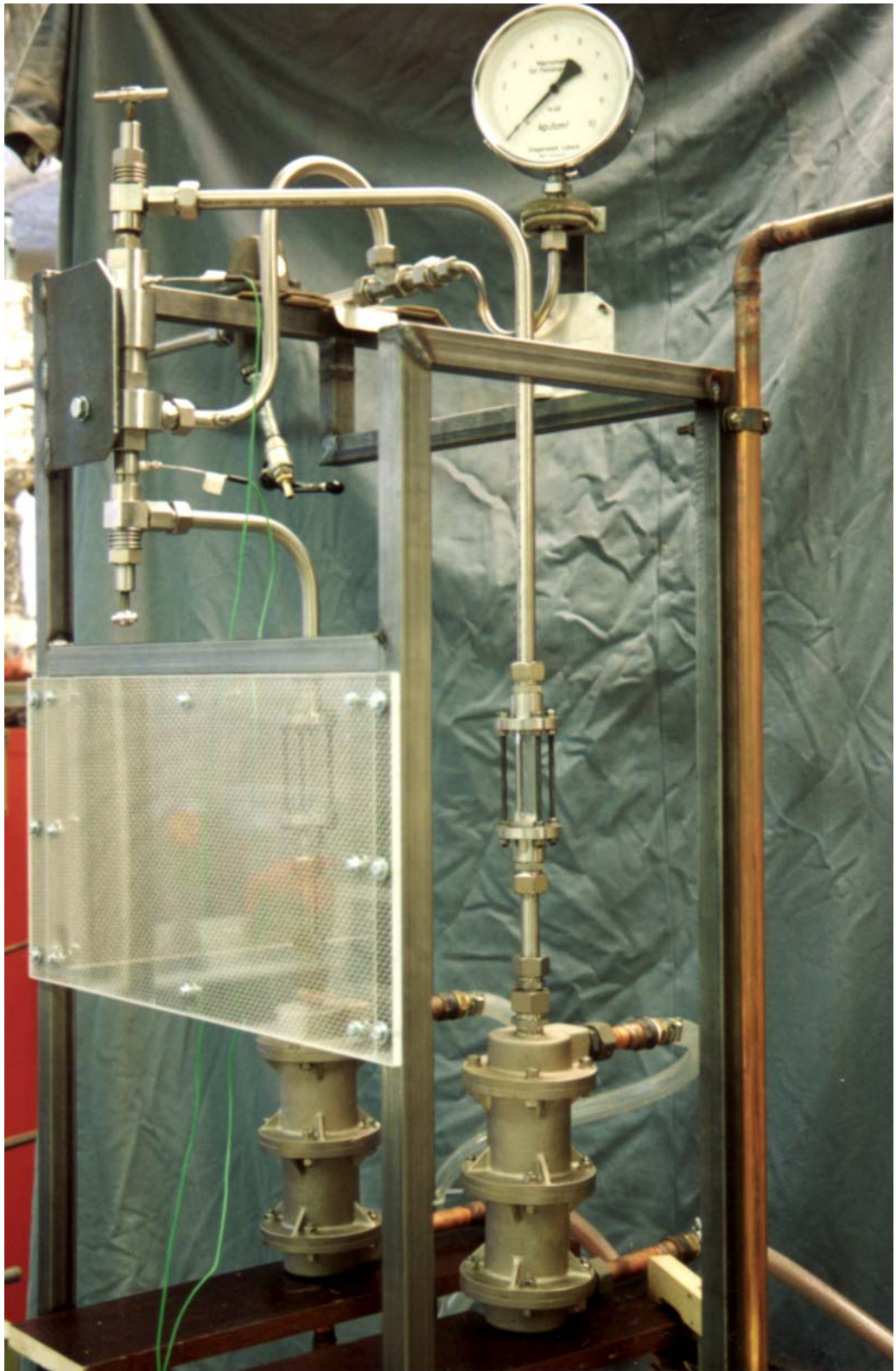
Fig. 7: Wirbelrohr zur Entspannung von Wasserdampf. Das Rohr befindet sich mit lotrechter Achse links oben im Bild. In der Bildmitte unten sind 2 mit Kaltwasser betriebene Kondensatoren sichtbar. Diese werden benötigt, um die
