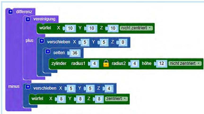
Abb. 2. Puzzelartige Anordnung eines Beispiel-Codes in BlocksCAD
