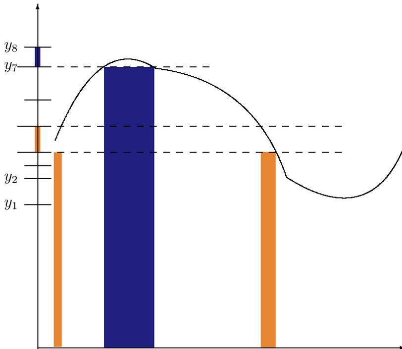
Abbildung 1.2: Das LEBESGUE-Integral einer Funktion  $f : [a, b] \rightarrow \mathbb{R}$ . Das Integral ist der Grenzwert der Summe  $\sum_{k=1}^n y_k \cdot \mu(\{x; y_{k-1} \leq f(x) < y_k\})$ .
