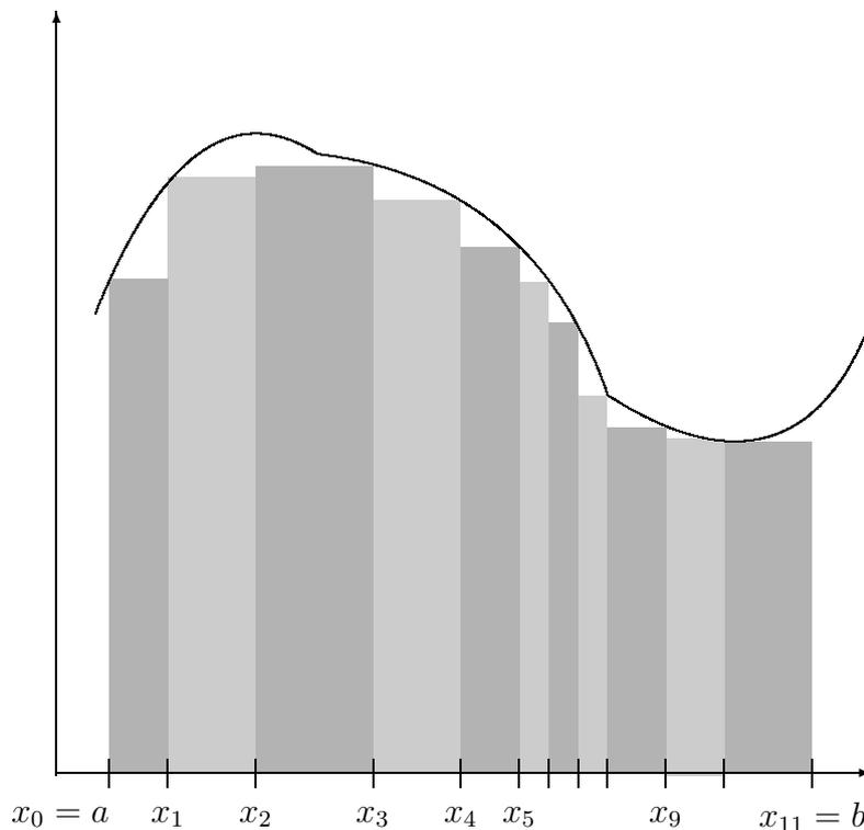
Abbildung 1.1: Das RIEMANN-Integral einer Funktion  $f : [a, b] \rightarrow \mathbb{R}$ . Das Integral ist der Grenzwert der Summe  $\sum_{k=1}^n \inf_{x \in [x_{k-1}, x_k]} f(x)(x_k - x_{k-1})$ .
