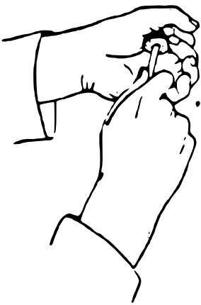
Abb. 1.8: Bohren von Stopfen mit dem Stopfenbohrer
