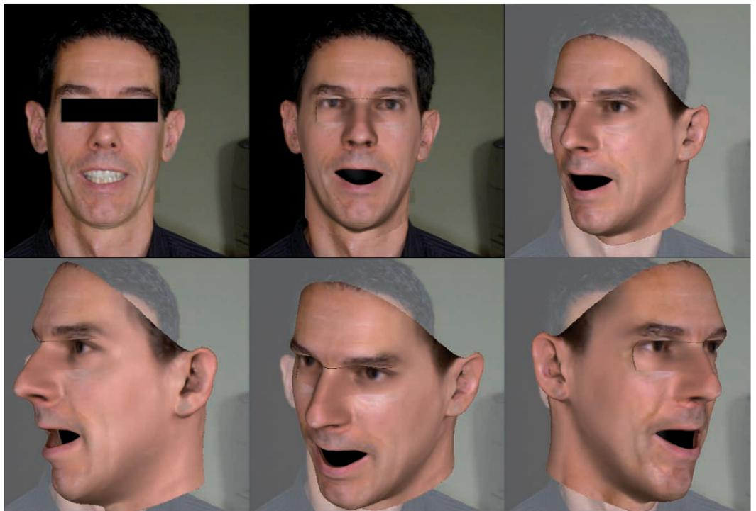
Aus einem 2D-Foto entsteht ein 3D-Modell, das gleichzeitig fehlende Bereiche wie die Augenpartie rekonstruiert. Zähne werden in diesem Modell nicht repräsentiert.
