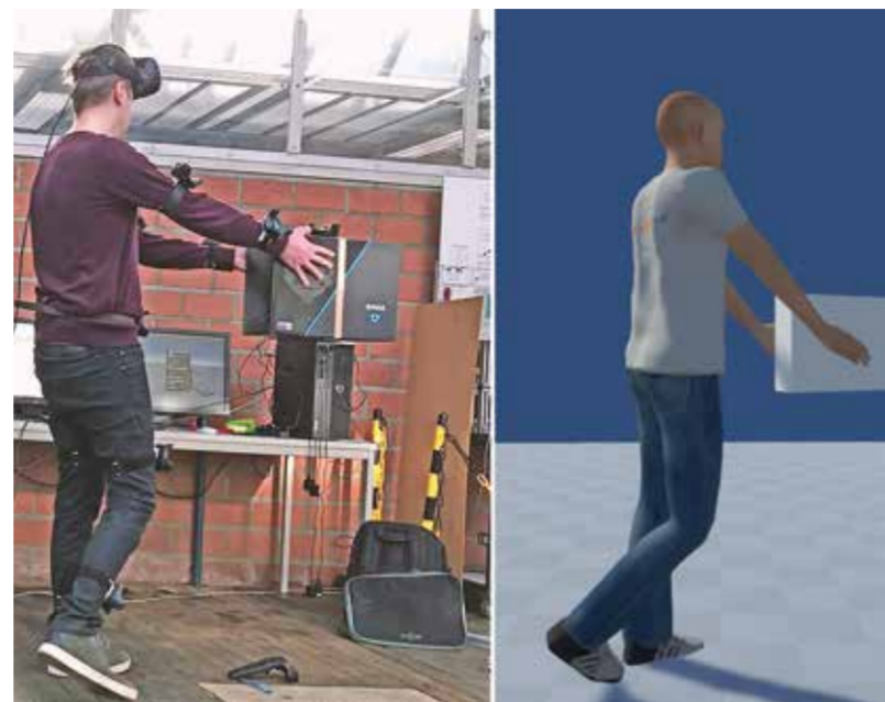
Sensoren zeichnen menschliche Bewegungen auf, die live auf einen Avatar übertragen werden. Auf Basis dieser Daten werden Bausteine für Bewegungssimulationen erzeugt.
