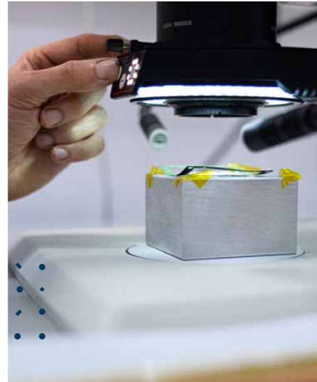
Die visuelle Inspektion des ITk-Pixelmoduls unter dem Mikroskop ist ein sehr wichtiger Teil des Montageverfahrens.
