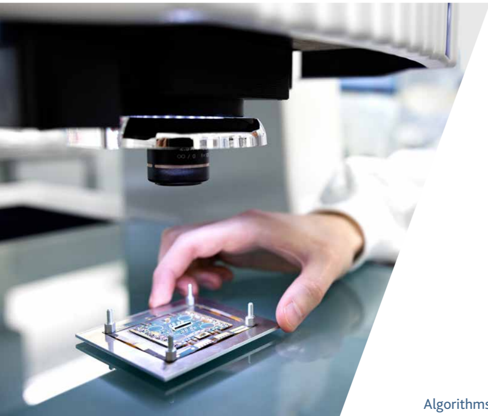
Ein ITk-Pixelmodul auf dem Koordinatenmessgerät während des Messvorgangs. Die Parameter müssen den Spezifikationen mit einer Genauigkeit im \mu\text{m} -Bereich entsprechen.
