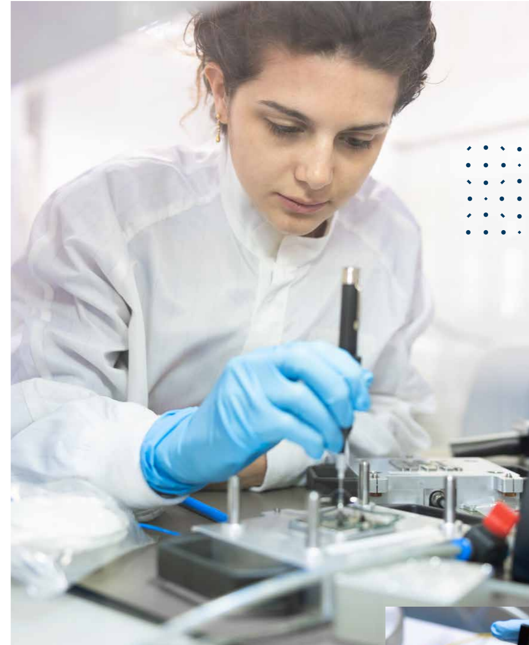
Ein ITk-Pixelmodul wird auf dem Montagewerkzeug positioniert. Jedes Pixelmodul besteht aus zwei verschiedenen Teilen: dem Rohmodul und dem Modul-Flex. Im Reinraum fügen die Physikerinnen und Physiker die beiden Teile mit einem speziellen Klebstoff und sonderangefertigte Werkzeugen zusammen.
