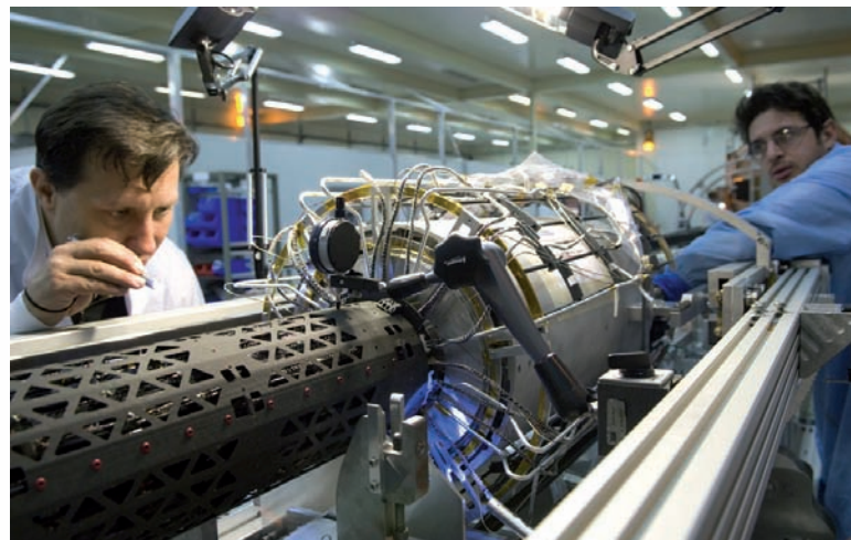
Links im Bild: Der ATLAS-Detektor im Oktober 2006. Noch fehlt der letzte Baustein: der Pixeldetektor. Bild Mitte, Bild links: Impressionen des Zusammenbaus des Pixeldetektors. Voraussichtlich Ende Mai wird der Pixeldetektor eingebaut.
