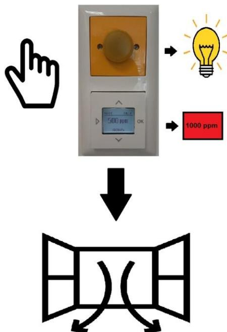
Der Wert CO<sub>2</sub> in ppm dient der Überwachung der Raumluftqualität und als Maßstab wann gelüftet werden sollte. Der CO<sub>2</sub> Wert von Außenluft beträgt ca. 500ppm.
