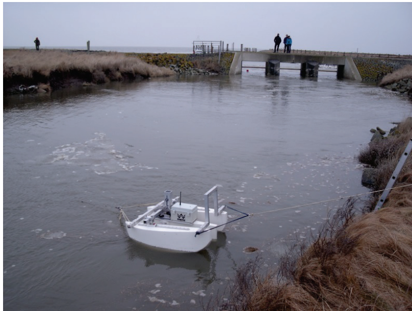
Abb. 45 Measure Cat Teledyne RD Instruments Sentinel ADCP im Osterwehl
