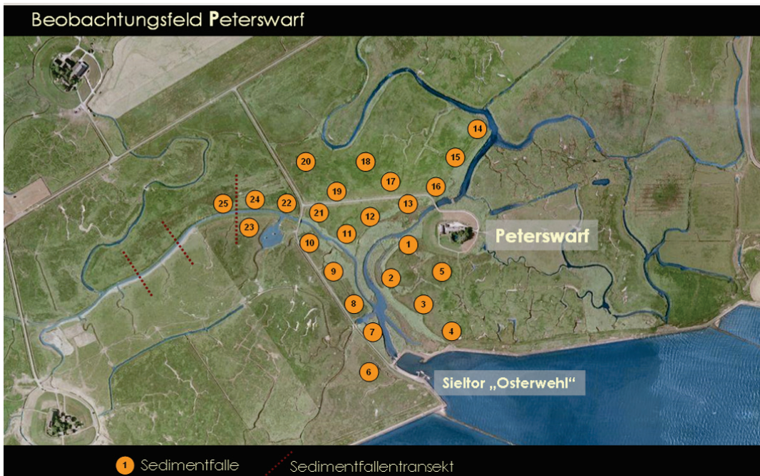
Abbildung 11 Übersichtskarte über das Einzugsgebiet des Osterwehl an der Peterswarf. Dargestellt sind die Standorte der Sedimentfallen sowie der Fallentransekte entlang des Binnenprielsystems.
