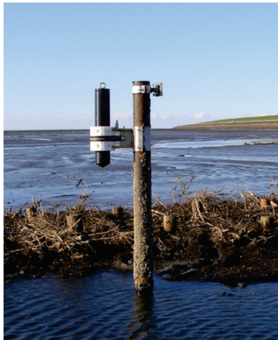
Abbildung 10: mobile Drucksonde für die Seegangsmessung
