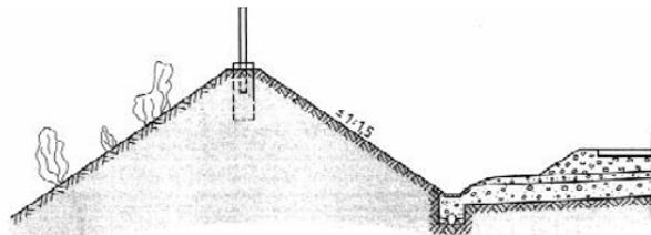
Abb. 2: Lärmschutzwallprofil nach WENDEHORST, Bautechnische Zahlentafeln [6]
