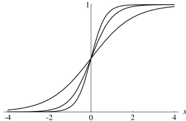
Abbildung 10.4: Sigmoidale Aktivierungsfunktionen. Quelle: [Roj96, S. 152]
