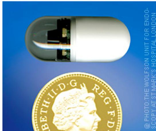
Abbildung 3.12: Kapsel mit Digitalkamera und Radiosender (Quelle: nobelprize.org)
