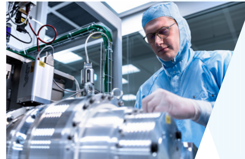
Masterstudent Lukas Giehl führt eine Wartung an einer Turbomolekularpumpe durch, mit der Vakuum für Dünnschichtprozesse erzeugt wird.
