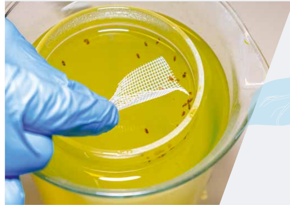
Dr. Sarah Hartmann sammelt Wasserflöhe (Daphnien) mit einem kleinen Netz aus dem Hälterungsgefäß ab, um sie in die Testküvette zu überführen.
