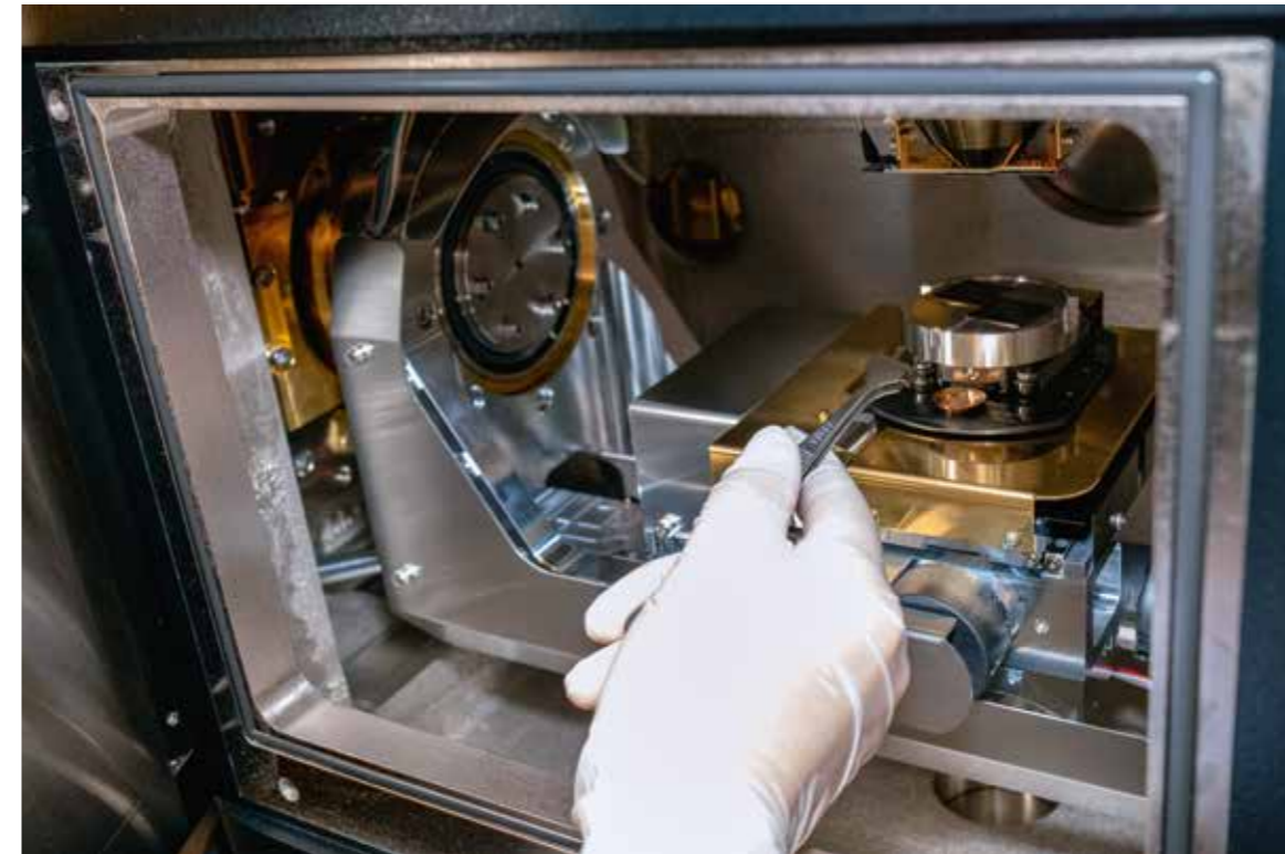
Eine Probe wird in die Vakuumkammer des REM geladen. A sample is introduced into the vacuum chamber of the SEM.
