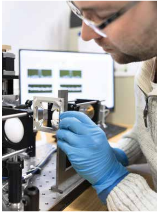
Der Biochip wird in das THz Messsystem eingebaut. The biochip is installed in the THz measurement system.
