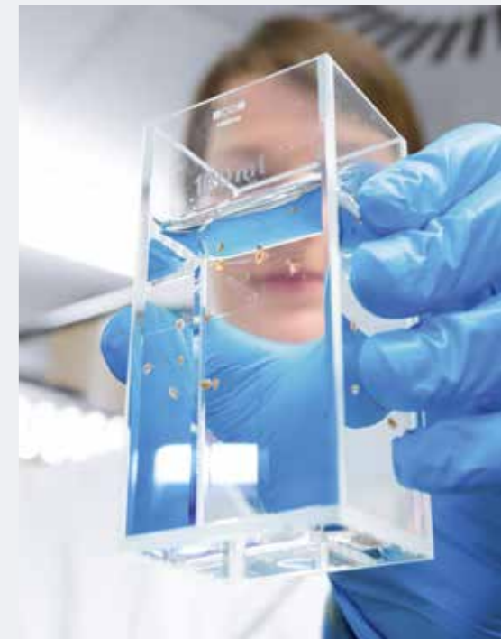
Die Wasserflöhe schwimmen in einer Testküvette (100 ml) in der Testlösung.
