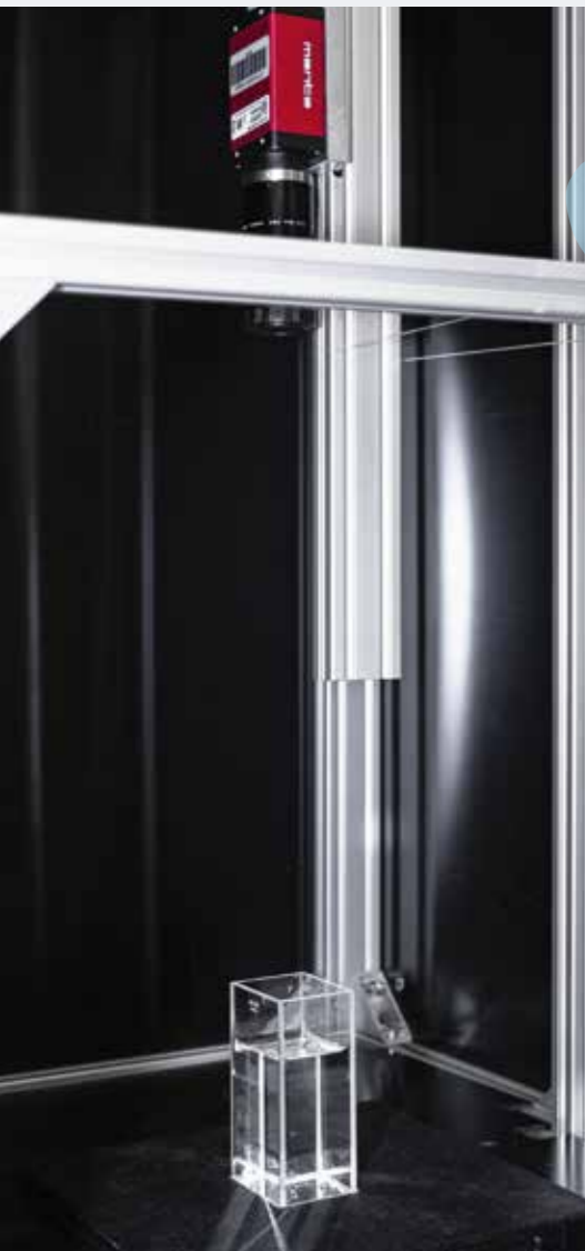
Die Infrarot-Kamera filmt die Daphnien in der Küvette von oben.
