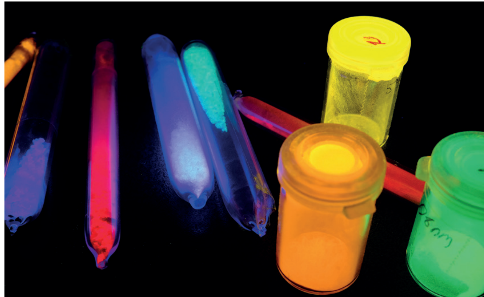
Emission von Nano-Leuchtstoffen unter UV-Licht
