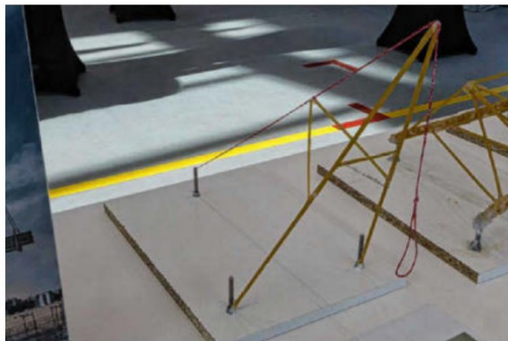
Der Gewinnerkran des Technikkollegs Siegen besteht aus „2,5 Nudeln“. Er hat den Stresstest nicht ganz heil überstanden. Insgesamt ist er mit 18 Gramm auch der leichteste Kran.
