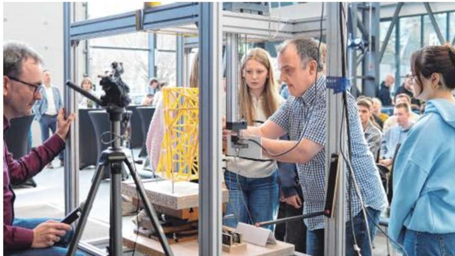
Getestet wurden die Pasta-Konstruktionen am Campus Buschhütten in einer hydraulischen Prüfeinrichtung.
