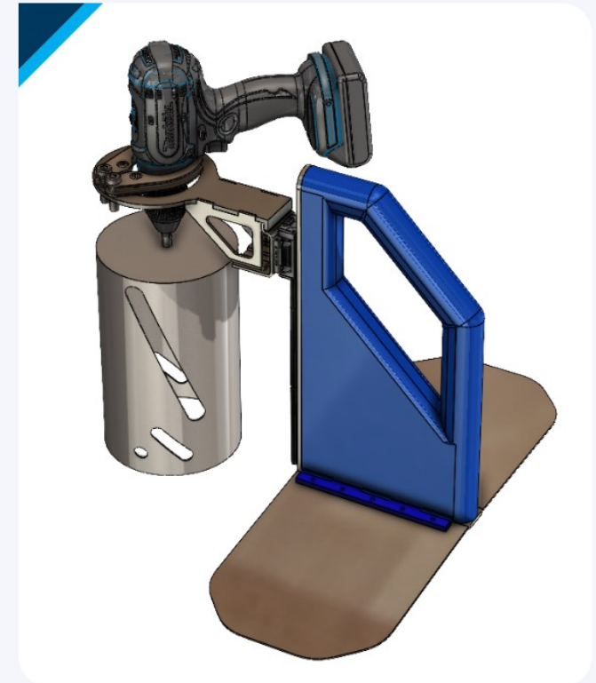
Lochsäge mit entnommener Flachdachprobe
