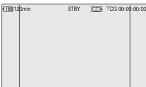
Wenn Sie „Aspect Marker“ auf „Mask“ stellen, können Sie außerdem mit „Aspect Mask“ die Helligkeit des Bilds außerhalb der Bildformatmarkierung einstellen. Hierbei kann aus einem Bereich zwischen 0 % und 90 % ausgewählt werden (in Schritten von 10 %).
