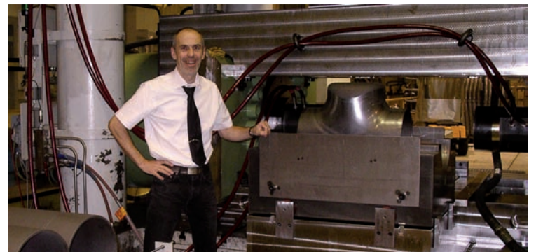
Markus Schellmann vor einer klassischen Anwendung der Innenhochdruckumformung bei Schuler Hydroforming: eine Maschine die Teile für den Bau von Pipelines produziert
