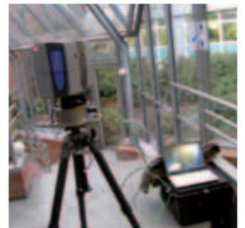
Terrestrischer Laserscanners Photon 80 der Firma FARO
