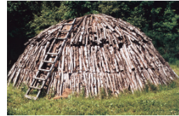
In Walpersdorf wird bis heute Köhlerei betrieben. Hier ein im Aufbau befindlicher Kohlenmeiler zur Herstellung von Holzkohle.
