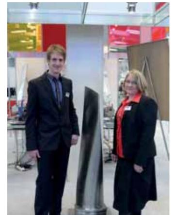
Werkstoffprüferin Lisa Häbel und Mitarbeiter Dipl.-Ing. Christian Freitag vom Institut für Materialkunde und Werkstoffprüfung mit dem Exponat. Dabei handelt es sich um eine von der Firma Siemens KWU AG hergestellte Niederdruck-Turbinenschaufel aus einer Dampfturbine. Die etwa 82 kg schwere Schaufel ist aus dem Werkstoff X20Cr13 gefertigt und besitzt eine Blattlänge von 1364 mm.
