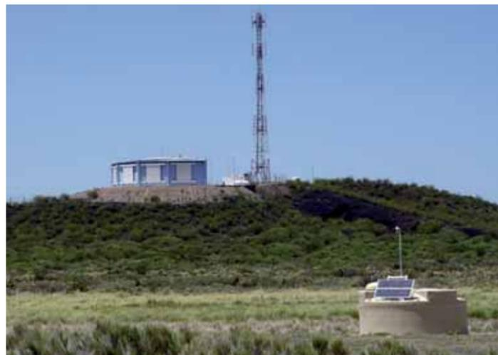
Auf einer Gesamtfläche von 3000 km<sup>2</sup> sind 1.600 Wasser-Cherenkov-Detektoren verteilt.
