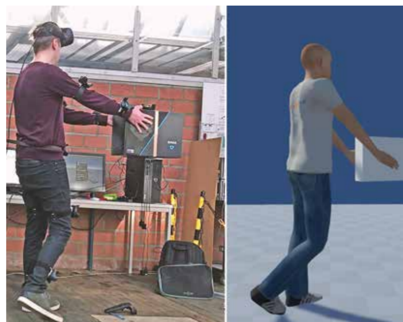
Sensoren zeichnen menschliche Bewegungen auf, die live auf einen Avatar übertragen werden. Auf Basis dieser Daten werden Bausteine für Bewegungssimulationen erzeugt.
