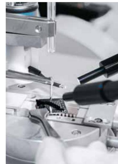
Graphen-Sensor im Bonding Tool
