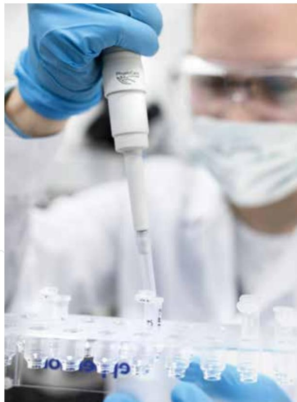
DNA wird in Pufferlösung auf den Biochip pipettiert. DNA is pipetted onto the biochip in buffer solution.
