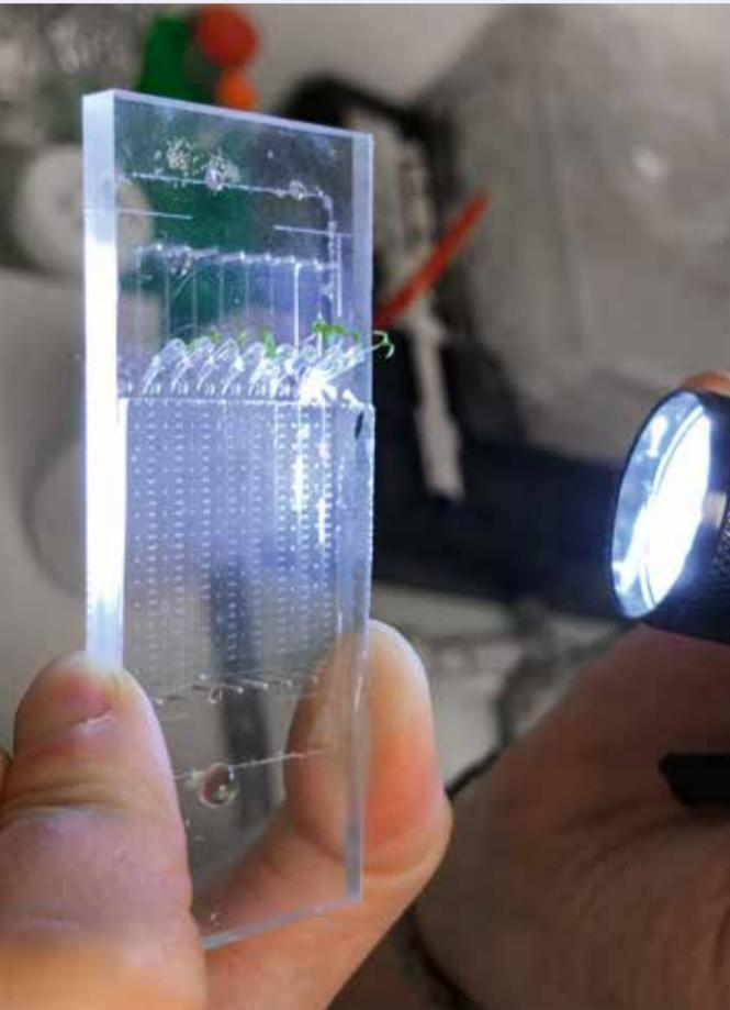
In das Mikroskop wird vor dem Flug der sogenannte RootChip eingebaut. Die eingewachsenen Arabidopsis thaliana (Ackerschmalwand) Keimlinge werden durch den RootChip während der Experimente mit Nährstoffen versorgt.
