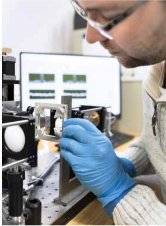
Der Biochip wird in das THz Messsystem eingebaut.
