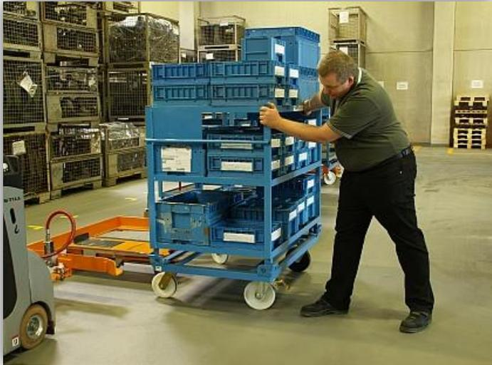
Manuelle Beladung eines Routenzugs mit KLT auf Trolleys (Hebezeuge+Fördermittel)
