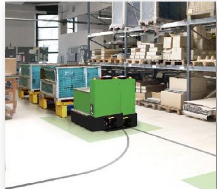
Automatischer Schlepplzug zum GLT-Transport mit optischer Spurführung, Beewatec
