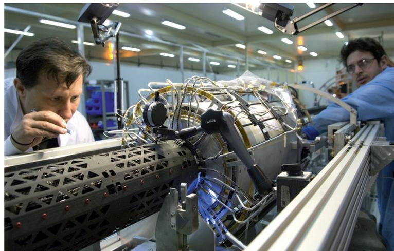
Wechselwirkungs-Ereignis entstehenden Teilchenarten bestimmen und analysieren. Als innerster Subdetektor von ATLAS trennen den Pixeldetektor nur Zentimeter vom Ursprung des Geschehens. Eine Digitalkamera könnte dieses etwa zweimal pro Sekunde festhalten; der Pixeldetektor muss 40 Millionen Mal bereit sein! Das schafft er nur, wenn jedes einzelne Pixel seine Information auf direktem Wege an die Ausleseelektronik weitergeben kann.
