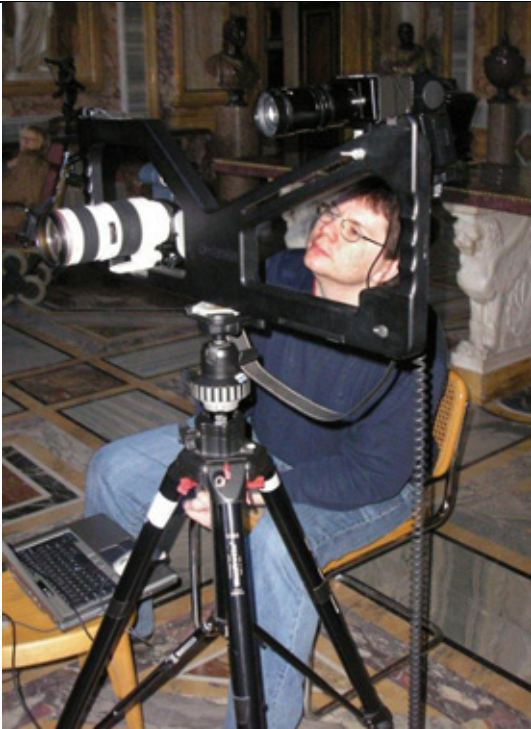
Roland Kuck vom Fraunhofer-Institut IAIS beim Abfotografieren der David-Skulptur in der Villa Borghese, Rom. Am Computer entsteht aus der Summe der Einzelaufnahmen das 3D-Bild.
