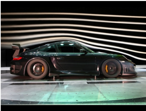
Umströmungsversuch im Windkanal
